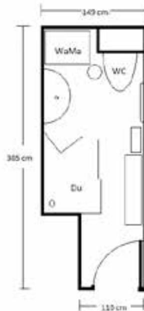
Abbildung 110: Verengung im vorderen Bereich des Badezimmers durch Wandvorsprung und Türblatt. In Ermangelung von Ablageflächen hat die Mieterin ein Regal gestellt, das den Durchgang zwischen Wand und Duschkabine weiter verengt. Sie kann ihren Rollator im Bad nicht benutzen, stützt sich stattdessen an der Wand ab. Duscheinstieg sehr schmal für Pflegeassistentz (Foto: SIBIS Institut).
