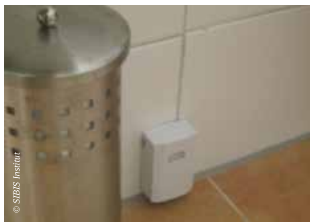
Wassersensor im Bad
