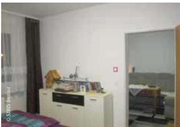
Wohnung 1, Blick vom Schlafzimmer (keine separate Tür zum Flur) in den Wohnraum; links neben der Tür der deutlich markierte Paniktaster, darunter der Lichtschalter
