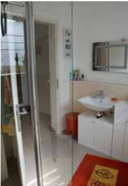
Abbildung 116: Großzügiger Grundriss, ebenerdige Dusche, Spritzschutz aus Glas, geräumig genug für Pflegeunterstützung (Foto: SIBIS Institut)
